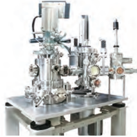
複合超高真空システム例 SEM + MBE + RHEED + STM + 4プローブ
